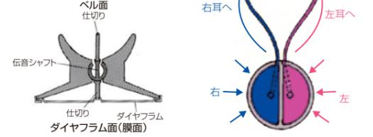
一体成型された中央仕切りをもつチェストピースがステレオ効果をもたらします。ダイヤフラム面・ベル面の切り替えは従来品と同じくシャフトを回すだけ。
